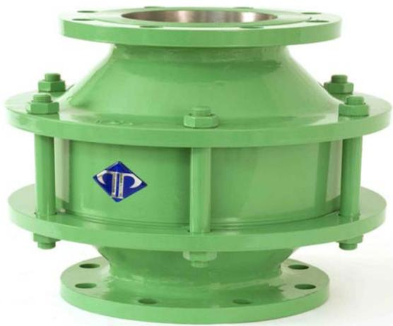
Esta configuración de lamina, aunada a la geometría de su construcción, tipo rombo; evita generar una caída de presión, esta es de tan solo 1" columna de agua. Cabe comentar que el área de extinción es 2 veces mayor a el área de conexión.
