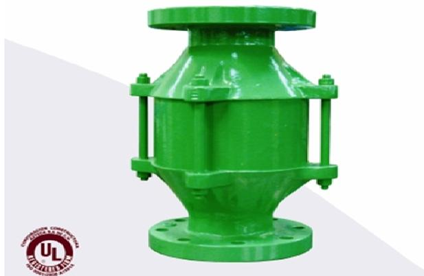
Esta configuración de lamina, aunada a la geometría de su construcción, tipo rombo; evita generar una caída de presión, esta es de tan solo 1" columna de agua. Cabe comentar que el área de extinción es 2 veces mayor a el área de conexión.
